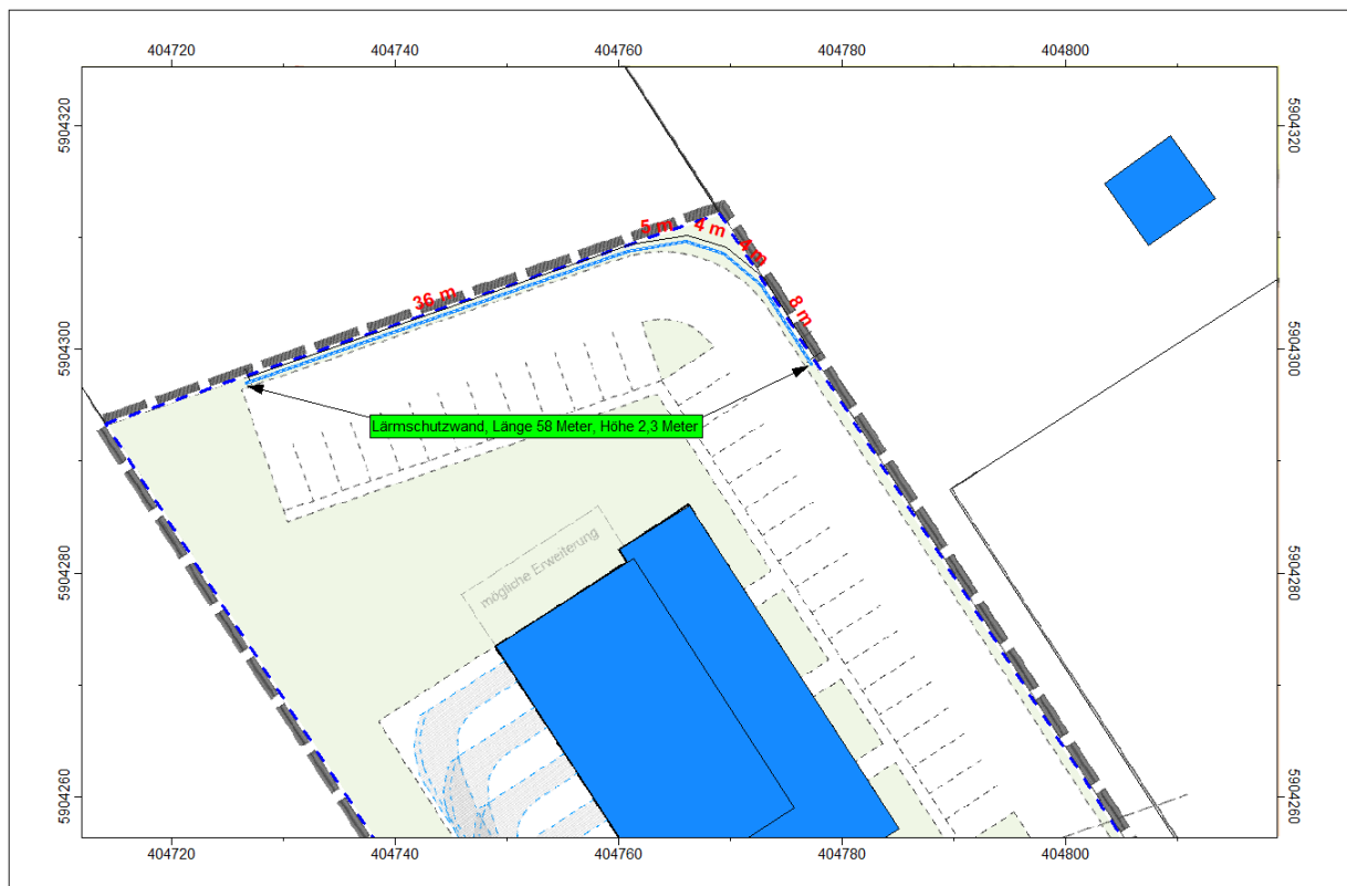
Abbildung 9: Lage der erforderlichen Lärmschutzwand (blau dargestellt).
